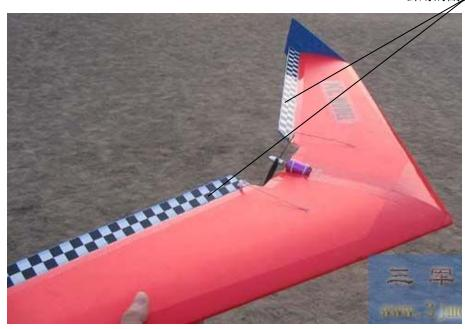
当需要升降时,遥控器 1 通道的副翼不动, 2 通道的升降动作,则两翼向相同方向动作,反映 在波形上是 1 通道的副翼与 2 通道的升降的脉宽一起变大变小,
