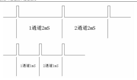
当需要横滚时,遥控器 1 通道的副翼动作, 2 通道的升降不动,则两翼向相反方向动作,一个向上一个向下,在波形上是 1 通道的副翼与 2 通道的升降的脉宽一个变大一个变小,
