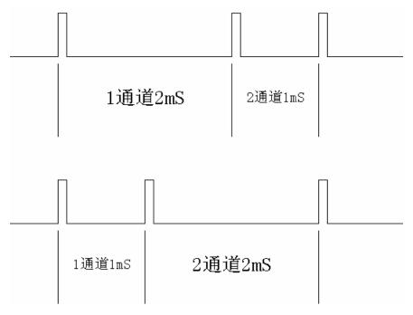
上述一个控制相同方向,一个控制相反方向,两个通道混合控制两个通道的方式叫做混控,如果两个通道分别是副翼和升降则叫做副翼升降混控,这种混控可以使飞机的副翼与升降翼合二为一;同理还有副翼襟翼混控用于飞机起降时增大升力和飞机巡航式减小阻力;副翼方向混控用于飞机转弯时实现协调转弯,内部人员只会感觉重力增加,不会有被离心力甩出去的感觉;油门升降混控用于飞机在空中加速时,此时速度增加则升力增加,飞机会上升,但我们只加了油门没有让飞机上升,这个混控可以在加油门时让飞机稍微低一点头,把刚才多产生的升力抵消一些,使飞机高度保持不变;以上为混控的意义。
