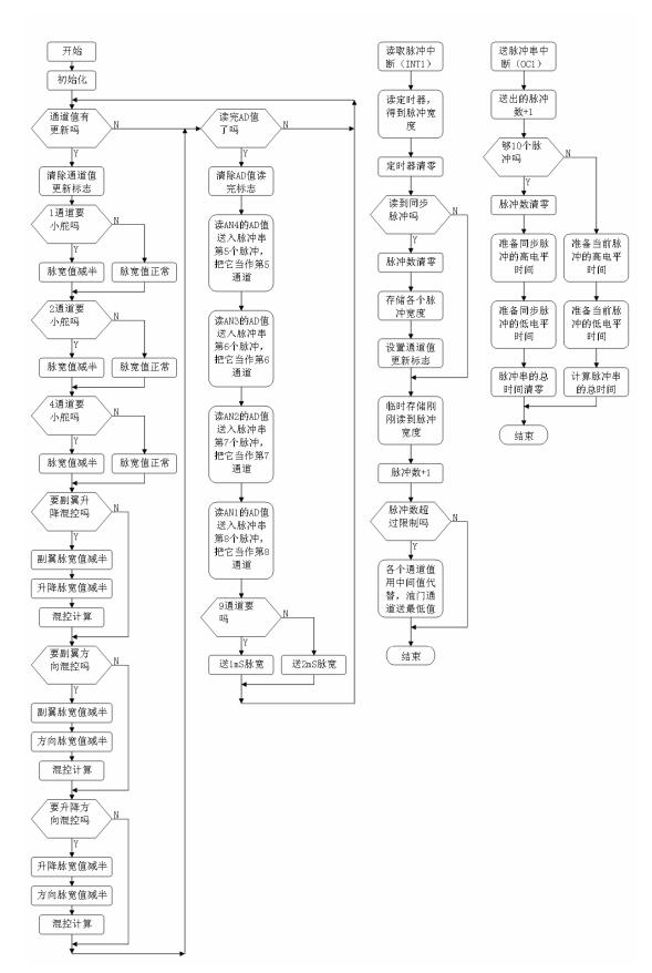
4.1 读取遥控信号(INT1中断):每个脉冲进中断一次,进入后读取脉冲宽度并判断是否
