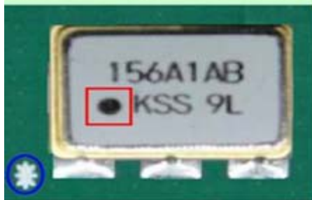
零件圆点对应PCB极性点
