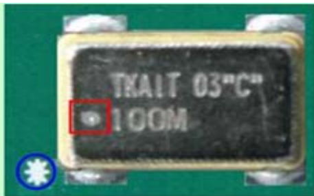
零件圆点对应PCB极性点
