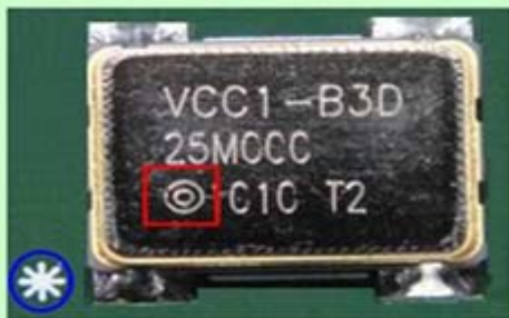
零件圆圈对应PCB极性点
