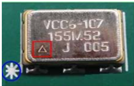
零件"△"对应PCB极性点
